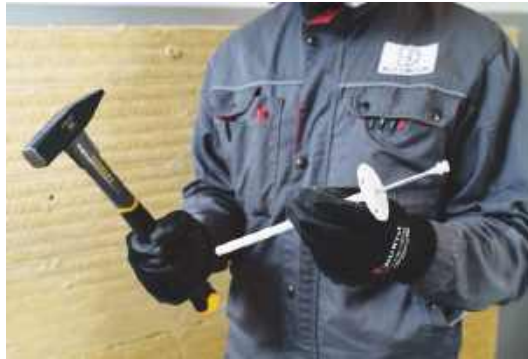
Рис. 5.17. Дюбель фасадний ThermoELF «Universaldübel» з розширеною розпірною зоною та пластиковою термоголівкою для кріплення мінераловатних і пінополістирольних плит
