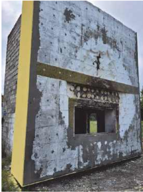
Рис. А.6. Витяг із Протоколу № 97/1-2022. Фрагмент фасаду після зняття залишків захисно-опоряджувального шару збірної системи фасадної теплоізоляції
