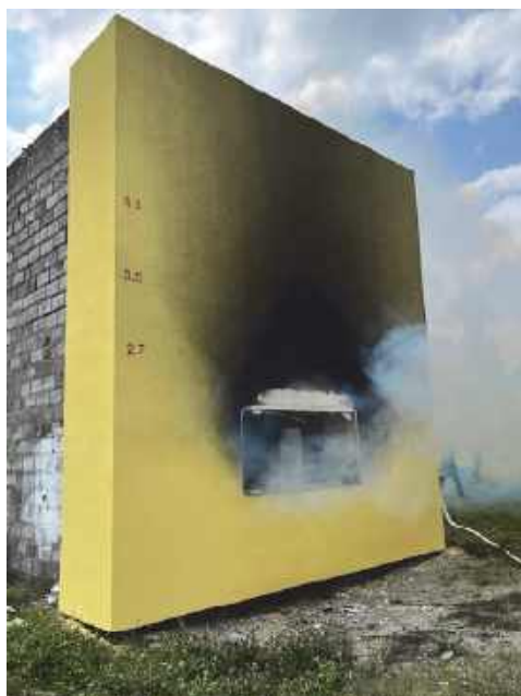
Рис. А.5. Витяг із Протоколу № 97/1-2022. Гасіння пожежі у вогневій камері
