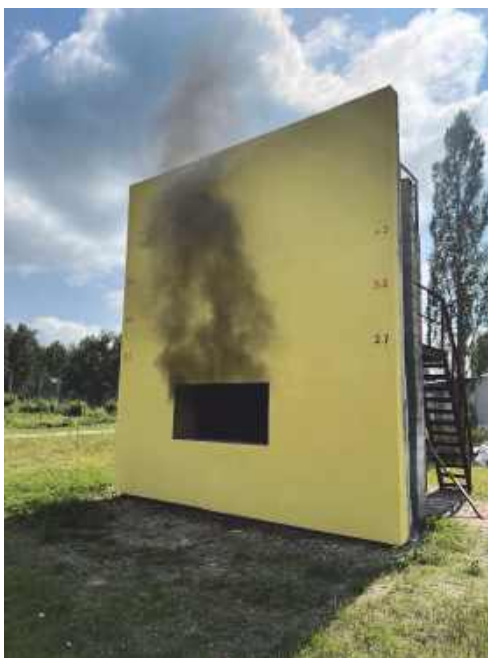
Рис. А.3. Витяг із Протоколу № 97/1-2022. Запалювання модельного вогнища всередині приміщення
