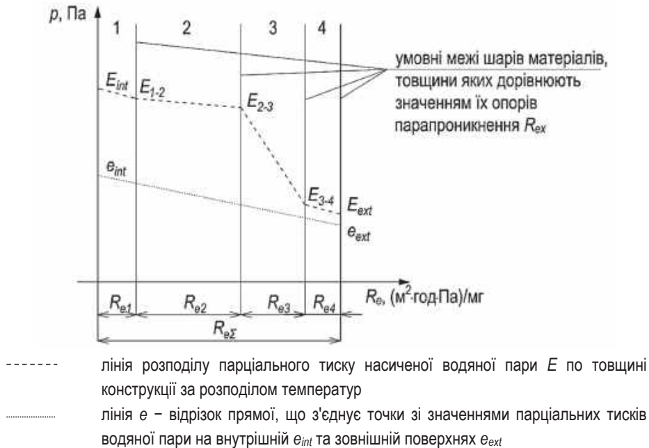
Рис. 2.2. Приклад розрахункової схеми аналізу розподілу парціальних тисків у товщі конструкції
