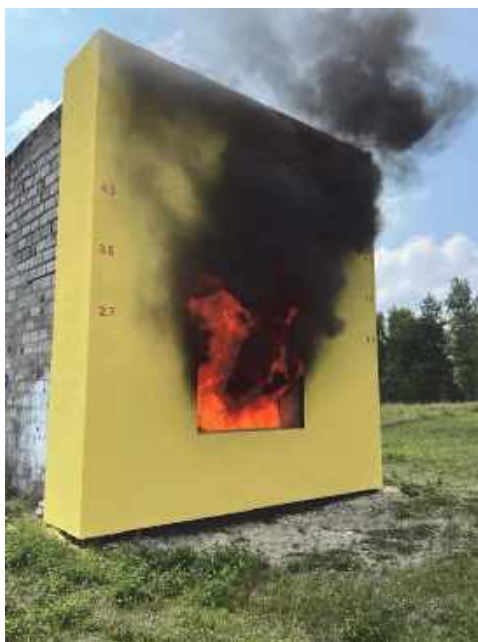
Рис. А.4. Витяг із Протоколу № 97/1-2022. Розповсюдження полум'я з віконного прорізу на висоту до 3,5 м через 30 хв імітації пожежі
