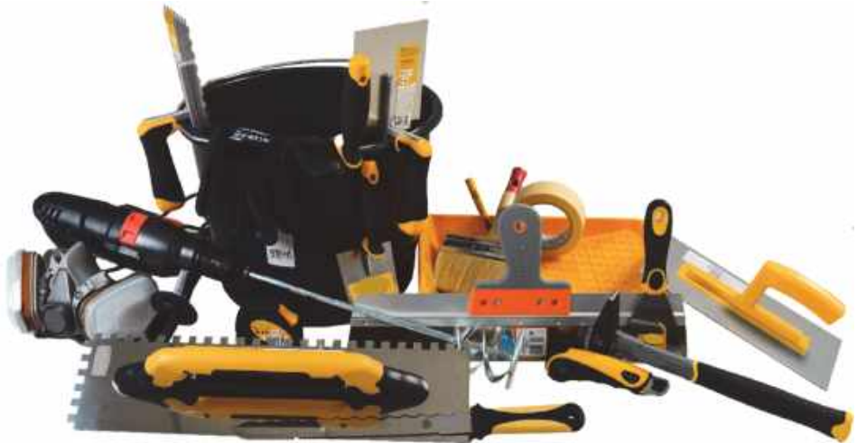
Рис. 5.1. Інструменти та обладнання, що використовуються під час улаштування фасадної теплоізоляції
